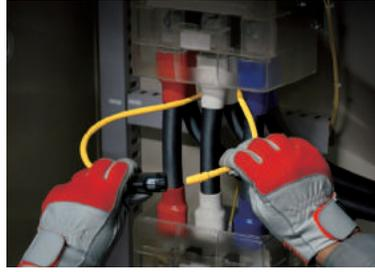
狹窄的場所或兩條配線、三條配線的電源電路中，可以使用柔性電流感測器。
